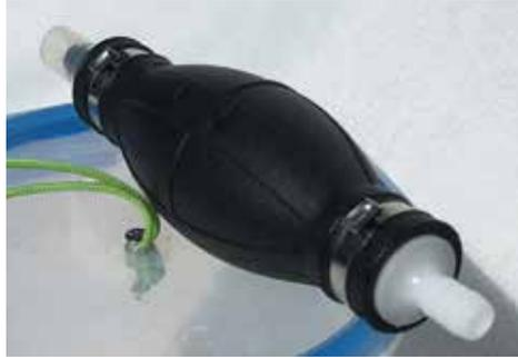
Die Schnur in der Mitte nutze ich zum Anhängen am Aquarium. Mit dem Abknicken des Schlauches, lässt sich der Durchfluss regeln. Bei Verstopfung lässt sich durch Pumpbewegungen die Glasspitze freispülen, so dass sich sogar auf Kies Planarien jagen lassen.
